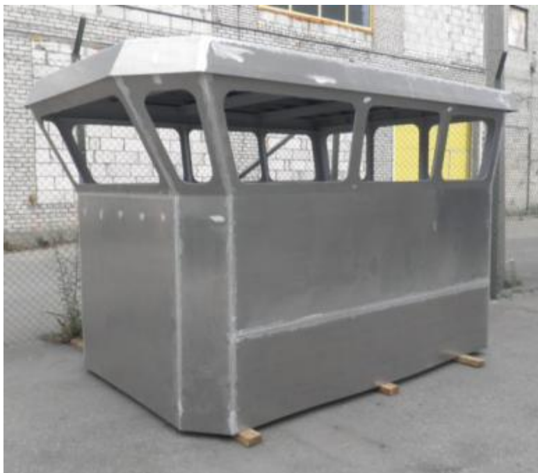
Рис.1.4 Секция надстройки алюминиевого катера длиной 14 м. Фото автора.
