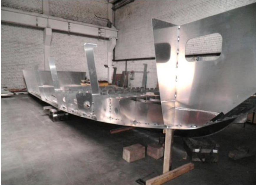
Рис 1.2 Сборка алюминиевого катера длиной 25 м детально-узловым способом. Фото автора.
