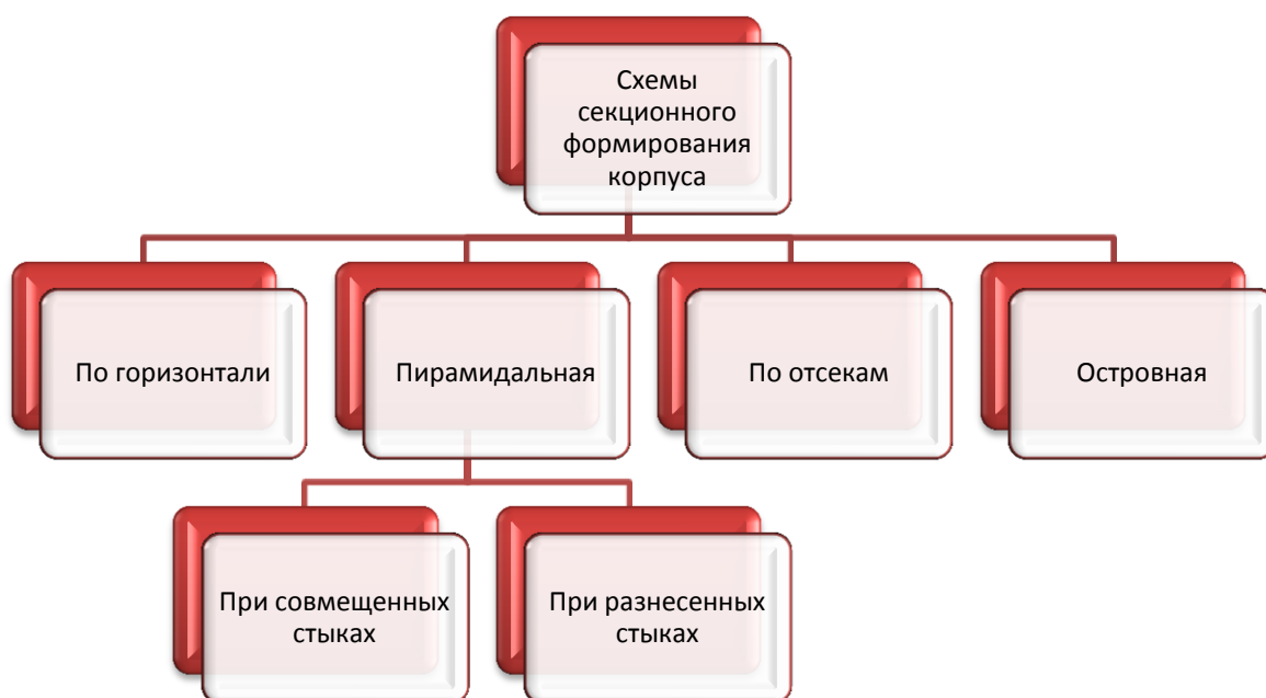
Рис.1.6 Схемы секционного формирования корпуса
