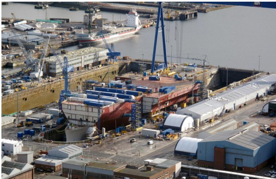
Рис.1.18 Сборка в сухом доке корпуса авианосца из блоков . Источник : http://fotoflota.livejournal.com/17421.html
