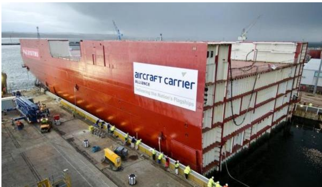
Рис 1.20 Заводка блока английского авианосца Queen Elizabeth в док Источник : http://fotoflota.livejournal.com/17421.html
