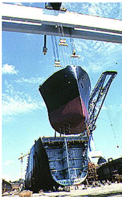
Рис 1.13. Подача блока носовой надстройки судна для соединения с корпусом.
