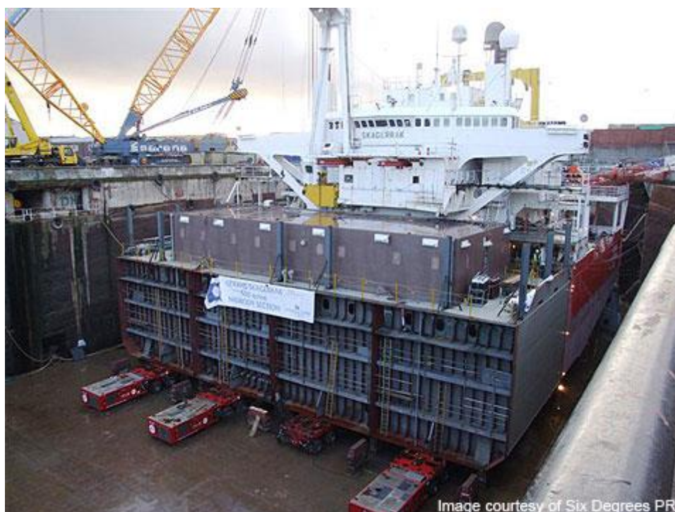
Рис.13.23 Транспортирование кормового блока машинного отделения на стапельное место, Skagerrak, Норвегия. Источник http://www.ship-technology.com/projects/nexansskagerrak/nexansskagerrak2.html
