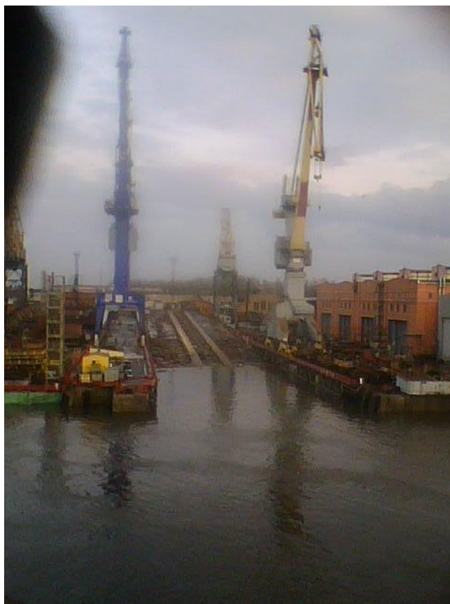
Рис. 13.14 Общий вид наклонного продольного стапеля.
