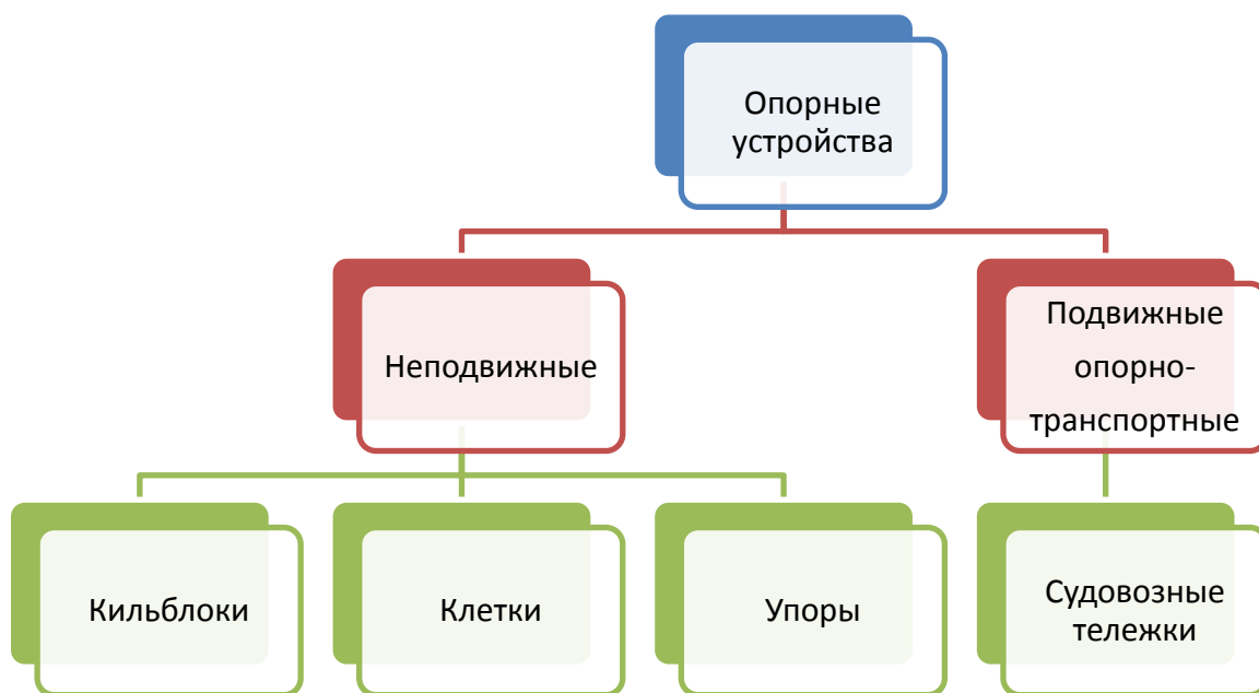
Рис. 13.4 Типы опорных устройств.
