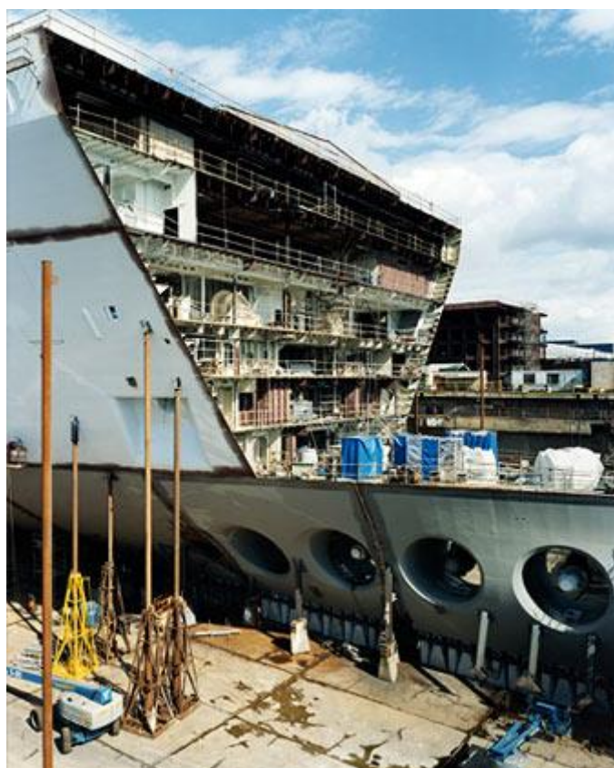
Рис.13.20 Установка днищевой носовой секции пассажирского судна «Oasis of the sea» на стапеле в сухом доке. Источник : http://www.worldculturepictorial.com/blog/content/at-sea-bigger-better-oasis-of-sea-largest-cruise-ship-tall-as-12-story-building-wider-than-panama-canal
