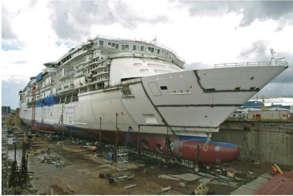
Рис. 13.2. Строительство корпуса пассажирского судна Freedom of the Seas в сухом доке в г.Турку, Финляндия. Источник: http://dreamdesignscolchester.weebly.com/2/post/2011/12/recognition-from-royal-caribbean-captain.html
